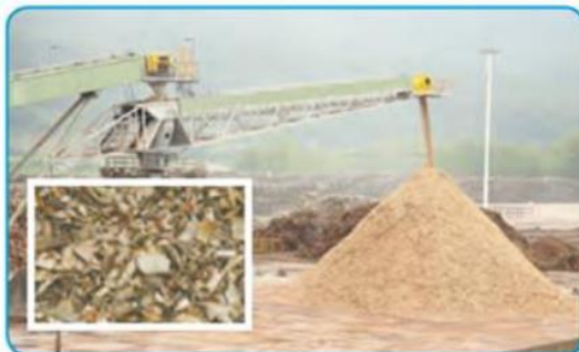
۴ تبدیل به تکه‌های ریز چوب (چیپس چوب)
